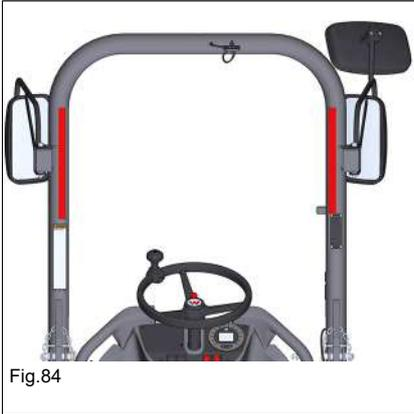
**Ajustar el espeje adicional (caja con dispositivo de carga automático y caja de volteo giratoria en altura)**
